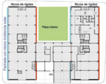
Incidencia solar a fachada
